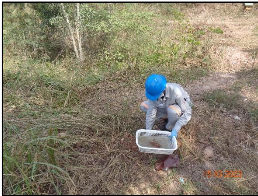
ภาพที่ 3.38 การตรวจวัดตะกอนดินบริเวณ บ่อดกตะกอน 1 (บ1)
